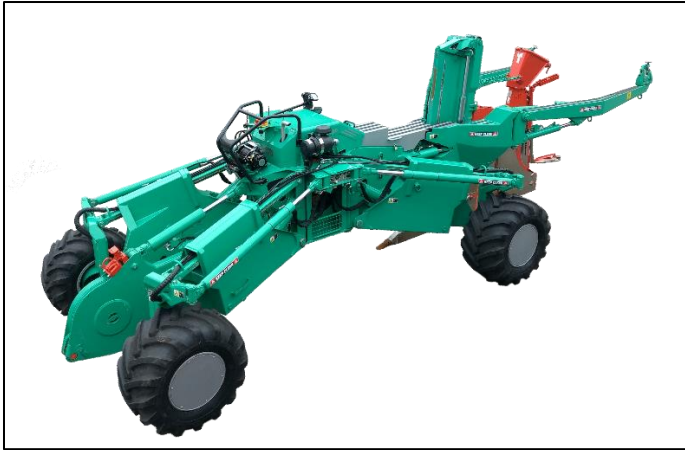
Bild 3. Der wendige Verlegepflug FSP 6 kann sich 1,95 m schmal machen und kommt mit einer Höhe von 2,91 m auch unter niedrigen Durchfahrten durch
