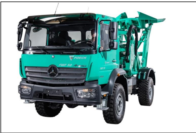
Bild 4. Ein ideales Verlegesystem: Der neuentwickelte FWF 50 eignet sich perfekt als Zugmaschine für den Verlegepflug FSP 6
