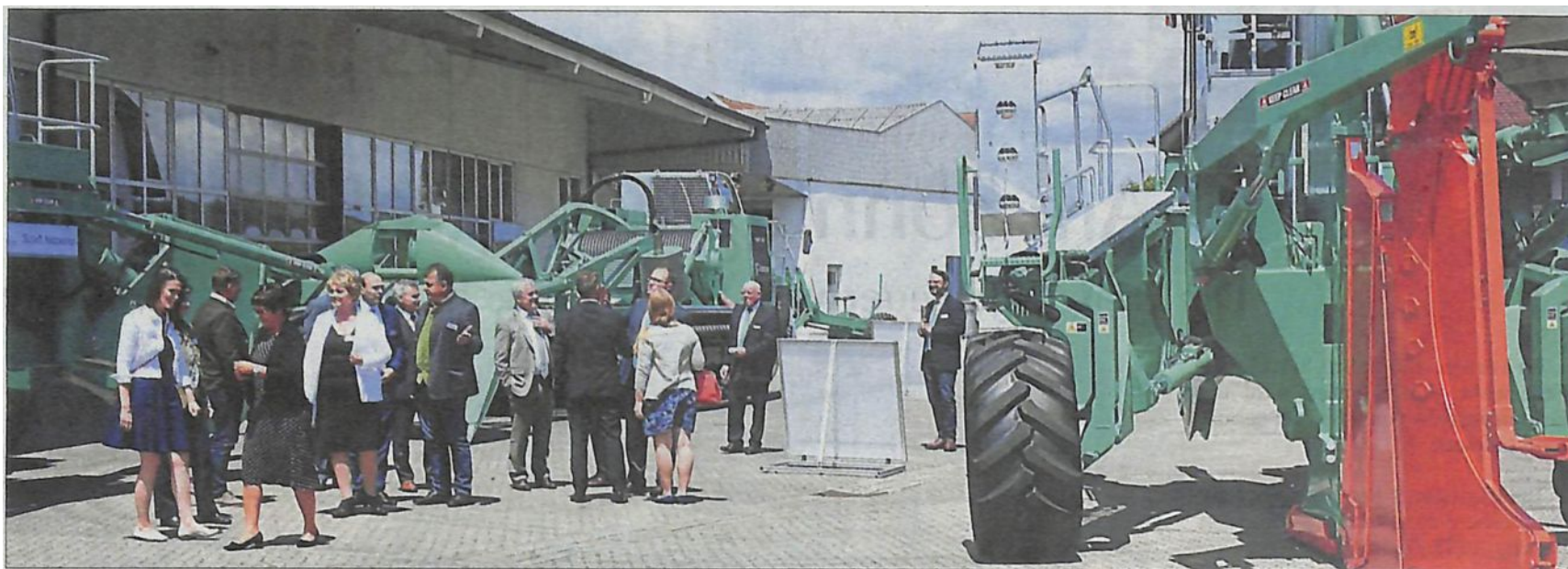
Rohre mit bis zu 63 Zentimeter Durchmesser können mit den Focke-Verlegepflügen schnell unter die Erde gebracht werden. Die Großgeräte haben schwenkbare Seilwinden mit bis zu 50 Tonnen Zugleistung und können mit einer Vierrad-Lenkung präzise gesteuert werden.
